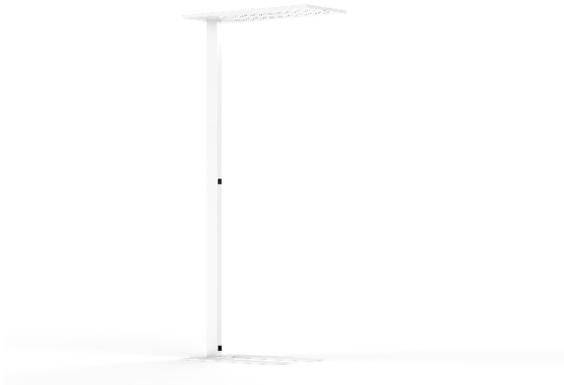
Stehleuchte aus Stahlblech mit direkt-indirektem Lichtaustritt, flache Bauform durch 20 mm hohes Gehäuse. Volltblindet nach DIN 12464-1 durch zurückgesetzte Linsentechnologie die ein komplett blendfreies Lichtbild bietet. Durch den Einsatz von Vollspektrum LED (CRI<97) erreicht die Leuchte ein angenehmes Lichtbild. Leuchte inkl. DALI Konverter. Touch DIM Fußplatte in U-Form, Standrohr, Leuchtenkopf Farbe RAL9016,
